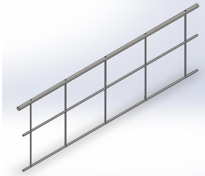
Figura 84 – Vista isométrica gaiola de proteção
