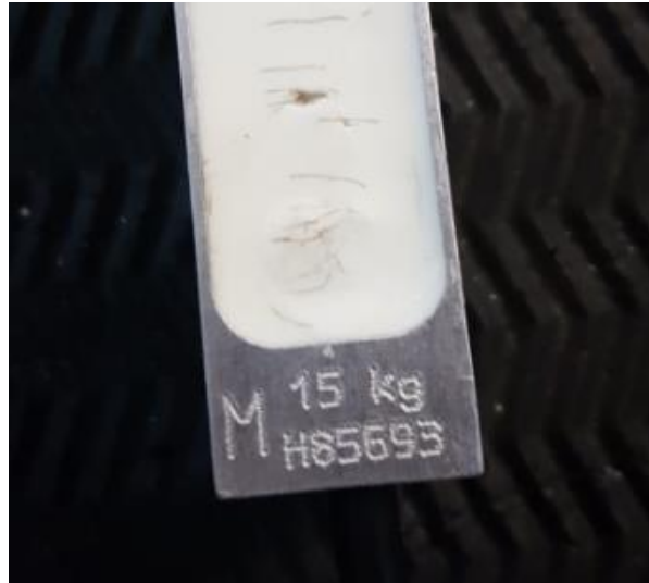
Figura 23 - Capacidade máxima de carga da Single Point Load Cell
