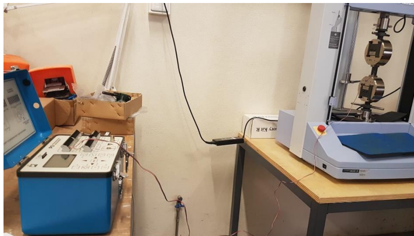
Figura 20 - Calibração do extensômetro com o P3
