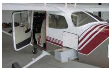
Figura 1. Avião Cessna 172 com plataforma para equipamento fotográfico.
