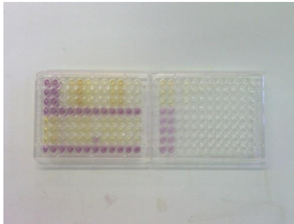
Figura 20 -Mistura resultante para posterior leitura espectrofotométrica para avaliação da atividade antioxidante pelo método DPPH.
