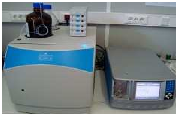
Figura 10: Registo fotográfico do sistema integrado de Polymer Laboratories PL-GPC-50 contendo o sistema SEC com refractómetro diferencial (RI) na gama de 950 30 nm ligado a um detector de dispersão de luz multi-ângulo (MALLS) Wyatt Technology DAWN8+ HELEOS 658 nm.
