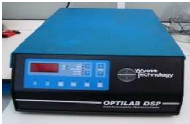
Figura 11: Registo fotográfico de um refractómetro OPTILAB DSP 633 nm interferometric da Wyatt Technology.
