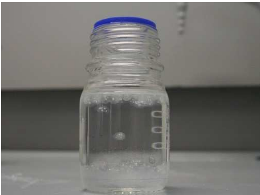
Figura 29: Foto elucidativa do inchamento das esferas (em DMF) produzidas na polimerização em suspensão com reticulação de estireno/divinilbenzeno (S3, tempo de polimerização aos 480 min).
