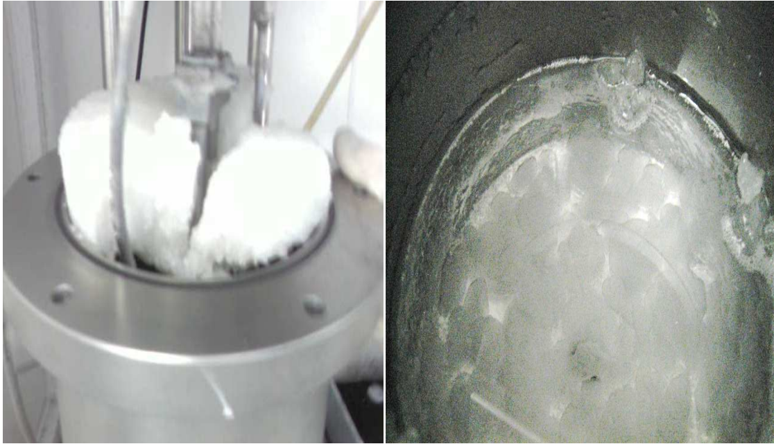
Figura 48: Registo fotográfico da agregação das partículas de gel às paredes do reactor mostrando a ocorrência de "coagulação catastrófica" (" catastrophic coagulation ") nas proximidades do ponto de gelificação.
