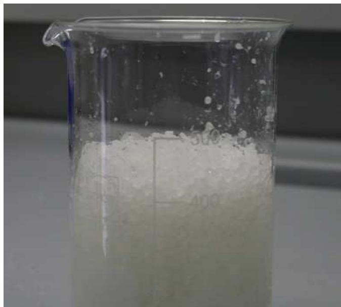
Figura 28: Foto elucidativa das esferas produzidas na polimerização em suspensão com reticulação de estireno/divinilbenzeno (S3, tempo de polimerização aos 480 min).
