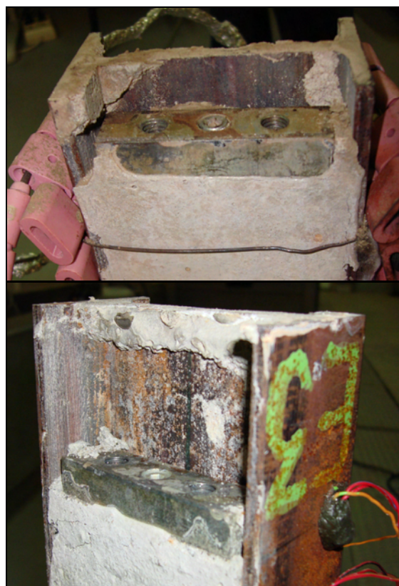
Fig. 8 – Estado limite último da viga parcialmente embecida, num ensaio de “push-out”.
