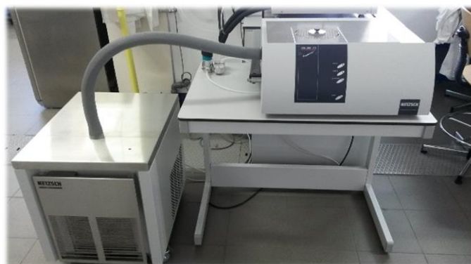
Figura 17 - Instrumentação TG e DSC usada na caracterização das propriedades térmicas dos copolímeros S/DIB produzidos.
