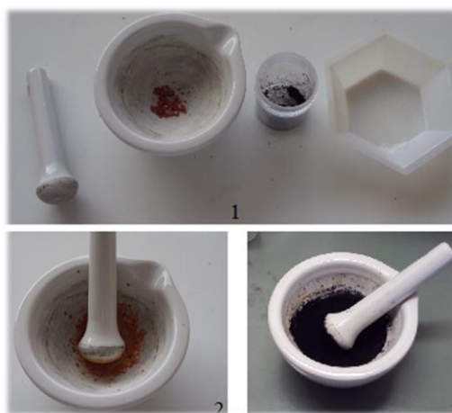
Figura 53 - Etapas do processo de preparação do filme polimérico (1 - copolímero poli(S-DIB), carbono condutor C65 e polietileno, quantidades preparadas na proporção 75:20:5; 2 - copolímero poli(S-DIB) fracionado e 3 - mistura perfeitamente homogênea dos reagentes, posteriormente adicionou-se o clorofórmio).
