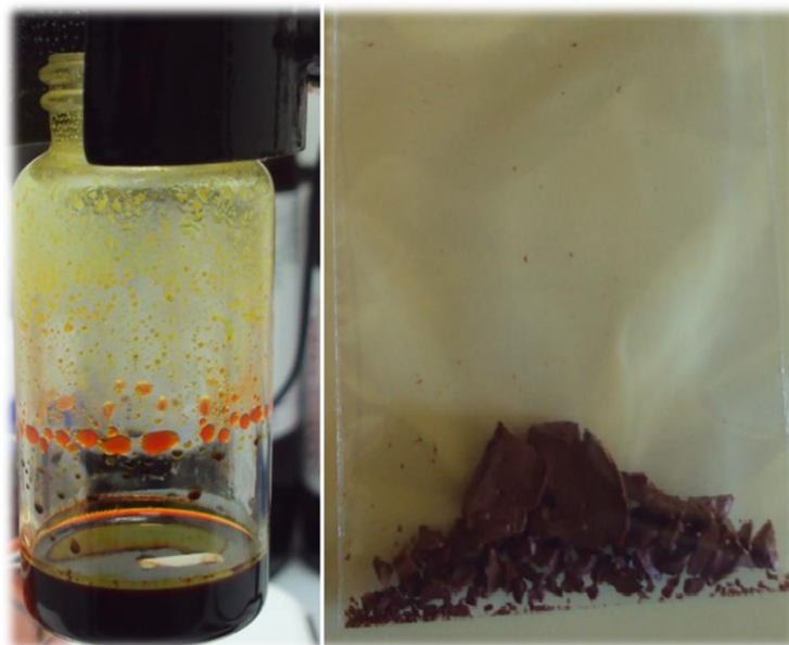
Figura 14 - Copolímero poli(S-DIB) 10 obtido da reação de vulcanização inversa nº 10. Na esquerda é mostrado o polímero obtido alguns minutos após a reação e à direita é apresentado o mesmo material com algum tempo de armazenamento.
