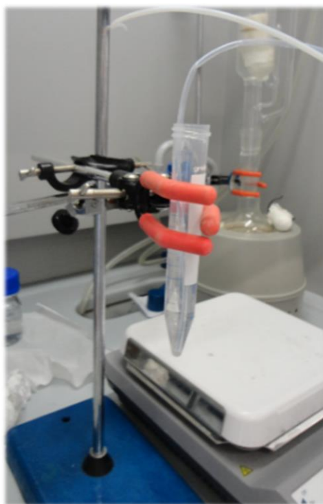
Figura 37 - Tetrahydrofurano a ser desoxigenado (10 mL, borbulhado com árgon durante 30 minutos) para ser posteriormente adicionado à mistura de reação de quebra das ligações S-S.
