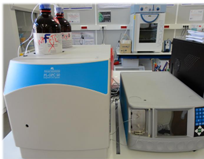
Figura 15 - PL-GPC-50 vista frontal com a porta fechada. À direita está representado o detetor MALLS.
