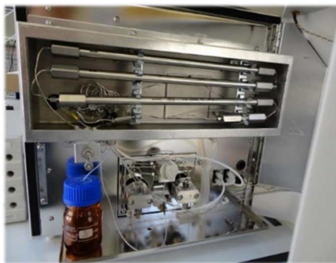
Figura 16 - Sistema PL-GPC-50, vista frontal com a porta aberta.
