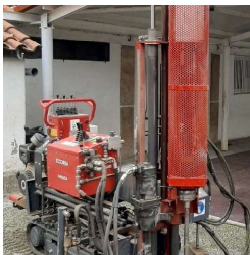
Figura 1 - Penetrómetro Dinâmico do Laboratório de Geotecnia do Instituto Politécnico de Bragança
