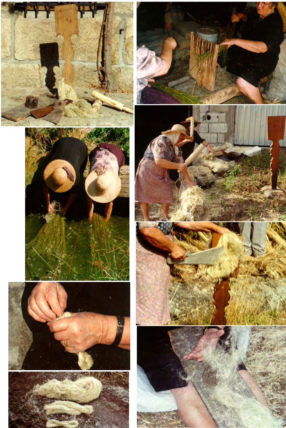
Figura 5.17 – Usos industriales de la flora del PNM, el lino: útiles, procesado y productos finales. Madeja de lino (la pequeña), estopeña (la media) y estopa (la mayor) en la foto inferior izquierda.
