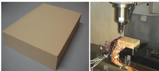
Fig. 1 Bloco da Sawbones e furação.
