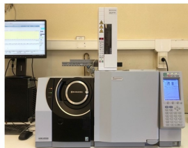
Foto 2. Sistema GC-MS equipado con automuestreador
