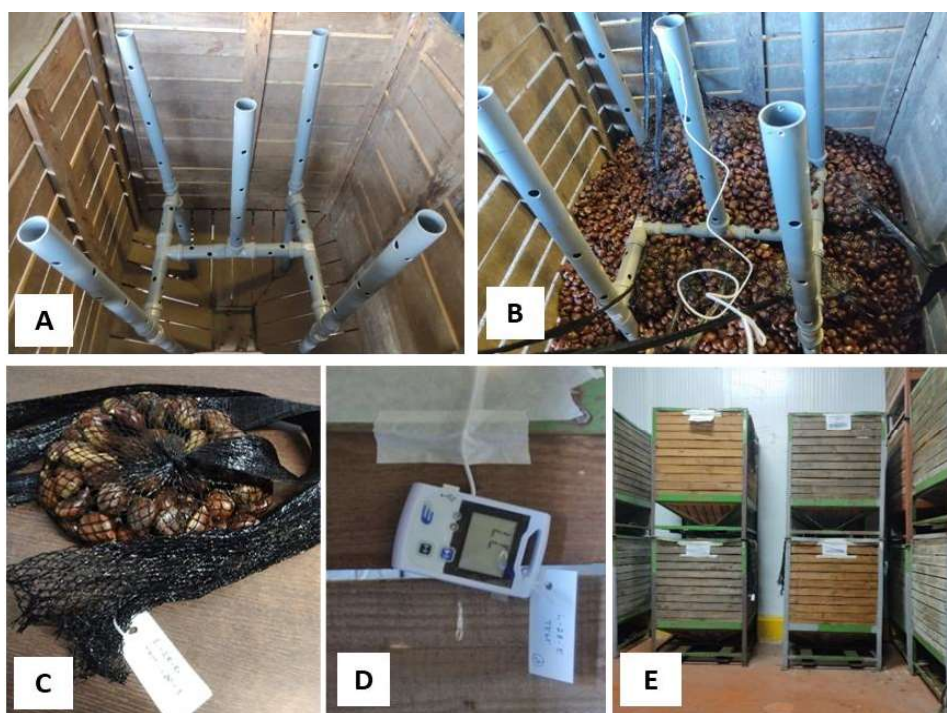
Figura 8. Sistema de arejamento montado nas caixas palete de castanhas: A) sistema de tubos perfurados; B) colocação de sacos de amostras e data loggers no centro de massa da caixa palete; C) aspeto do saco de amostra (1 kg de castanhas); D) detalhe do data logger ; E) armazenamento das caixas palete na câmara refrigerada.
