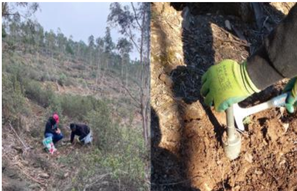
Figura 9. Colheita de amostras de solo nas parcelas do Campo Experimental Permanente. Fonte: Fonseca (2024).
