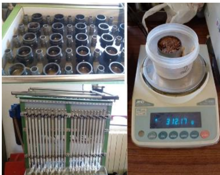
Figura 12. Utilização do permeâmetro para avaliação de parâmetros físicos do solo.
