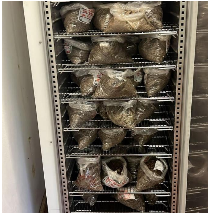
Figura 10. Amostras secando em estufa a 45°C.
