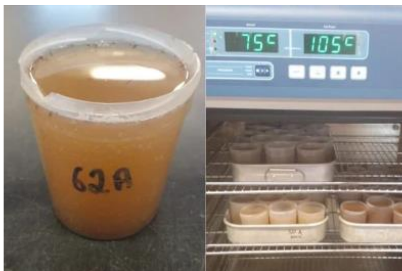
Figura 14. Amostras húmidas colocadas em estufa a 105°C.
