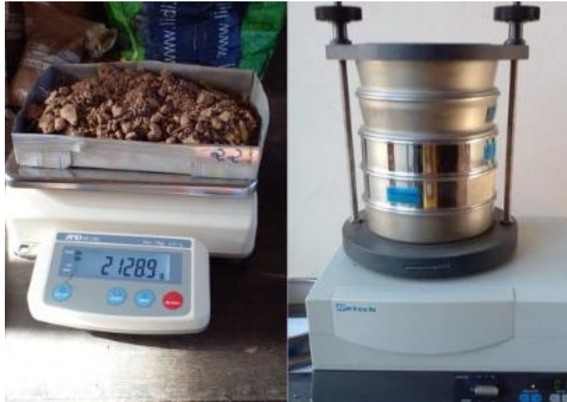
Figura 11. Pesagem e crivagem das amostras secas para separação dos elementos grosseiros.
