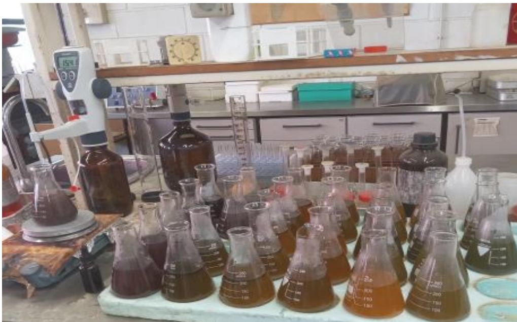
Figura 2: Determinação da matéria orgânica facilmente oxidável
