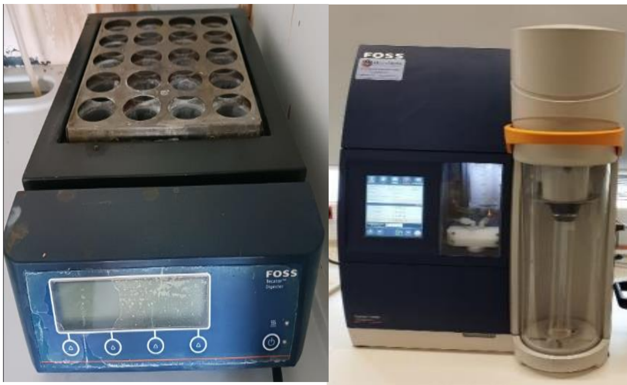
Figura 5: Equipamento de digestão (esquerda) e leitura automática do azoto no equipamento Kjeldahl a (direita)
