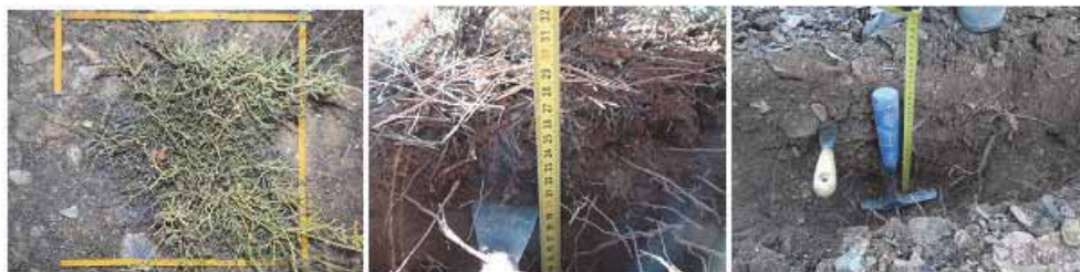
Figura 2. Observações de campo da superfície do solo (vegetação, resíduos vegetais e pedregosidade) e colheita de amostras a diferentes profundidades (0-10, 10-20 e 20-30cm).
