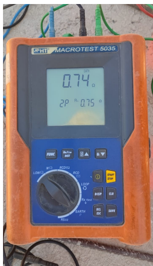
Figura 4.4: Medição da resistência de aterramento final [Autoria Própria].
