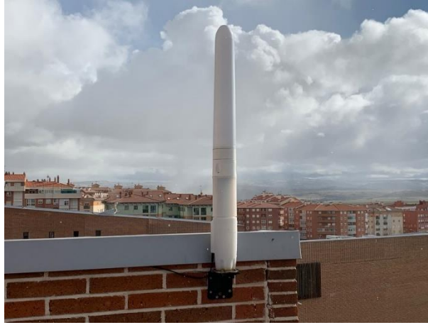
Figura 4-Sistemas eólicos sem turbinas a partir de um mastro de vidro e carbono (Fonte: Vortex Blandeless).
