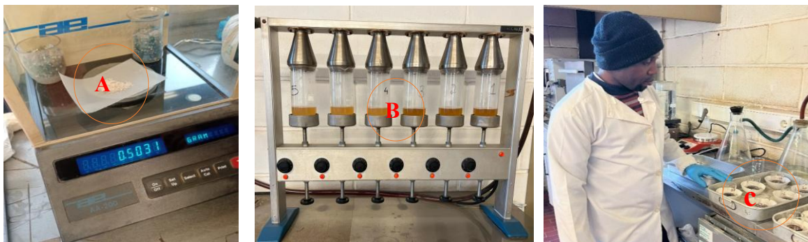
Figura 4 - A) Pesagem da amostra de ração para análise bromatológica; B) Processo de fervura para extração de fibras; C) Fibras submetidas à solução ácida durante a análise de fibra em detergente ácido (FDA).
