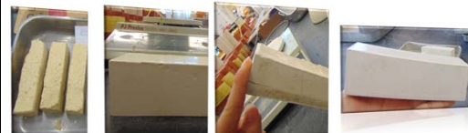
Calda de injeção com o plastificante PLUS, VHE, PLAST e SKY. Fonte: SANTOS, Jocileila L.; 2014.
