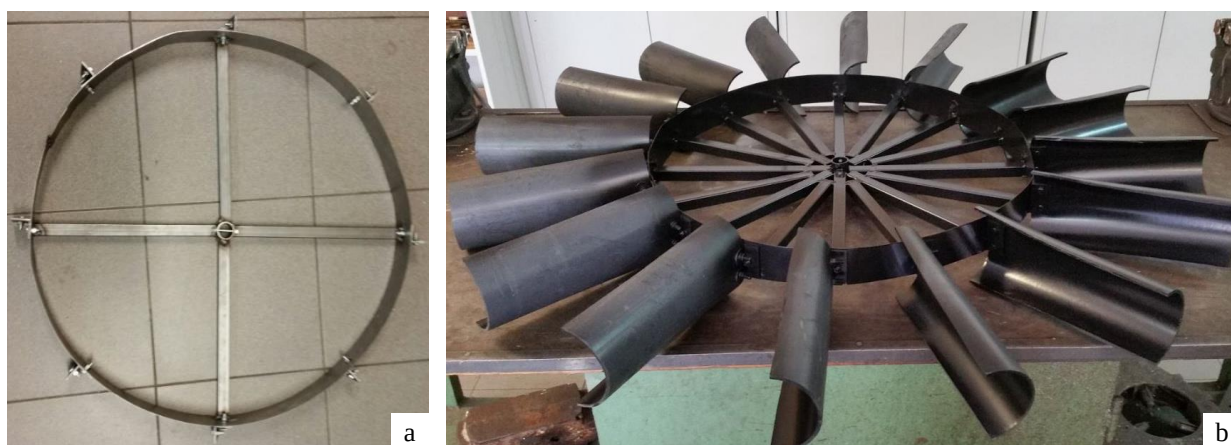
Fig. 3-7 – Protótipo de roda de água horizontal a) anel externo e braços maiores; b) versão inicial.
