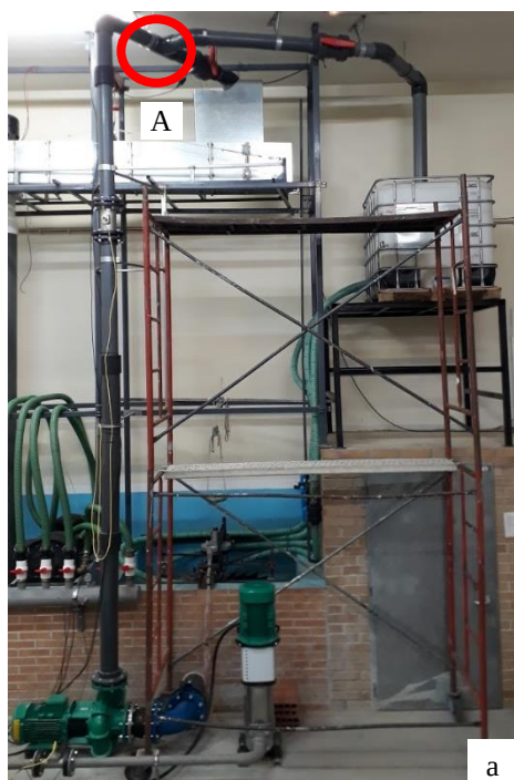
Fig. 3-17 – Plataforma: versão atual a) visão geral; b) vista superior do protótipo montado à estrutura de suporte. Det. A: derivação da tubagem para as unidades da plataforma.
