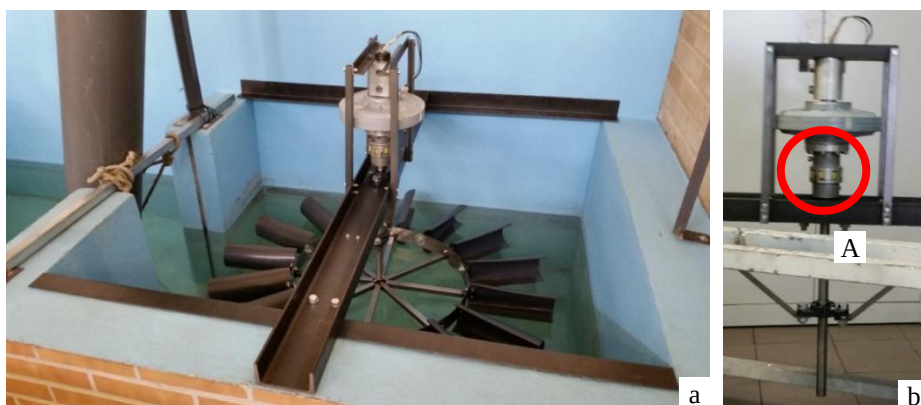
Fig. 3-6 – Montagem do conjunto a) visão geral; b) estrutura de suporte do gerador. Det. A: acoplamento do veio direto ao gerador.
