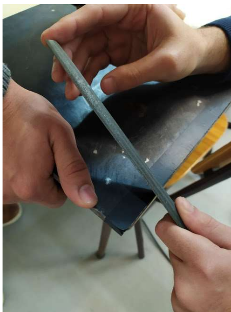
Figura 19: Rasgo para o direcionamento do fio sendo alargado com uma lima
