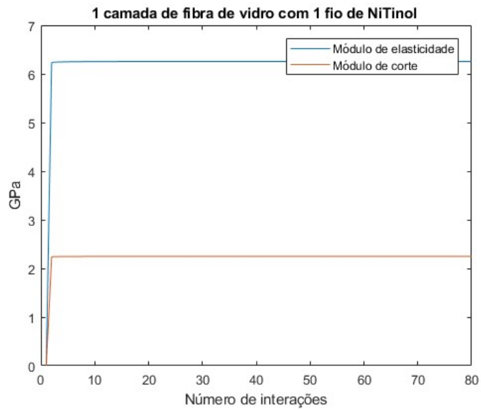
Figura A 12: Gráfico da evolução módulo de elasticidade e o módulo de corte de acordo com o número de iterações para a configuração com 1 camada de vidro e 1 fio de NiTiNol
