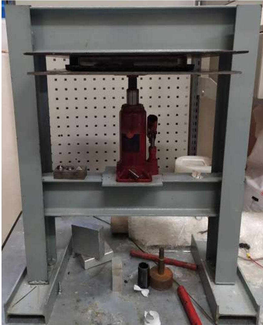
Figura 24: Local de prensagem da placa de compósito híbrido
