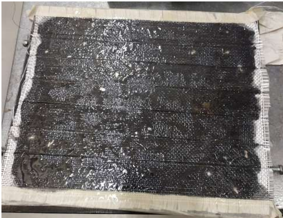
Figura 23: Uma camada de fibra, com o fio colocado e a resina aplicada
