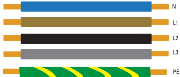
Figura 3.9 - Cores normalizadas dos condutores para corrente alternada [8]
