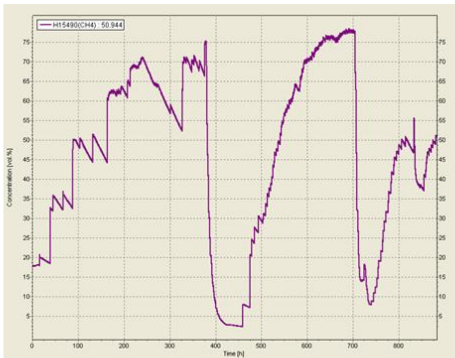
Figura 52 - Concentração de metano (%), na amostra da semana 19, operando com COV 0,45 kg CQO \cdot m^{-3} \cdot d^{-1} e QV 755 L \cdot m^{-3} \cdot d^{-1} .
