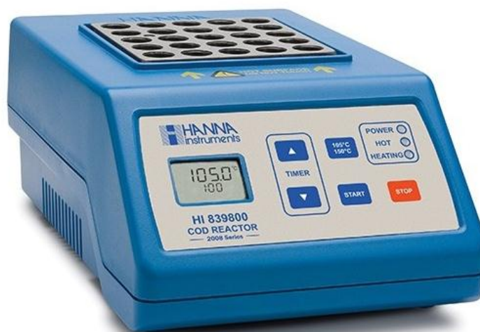
Figura 10 - Bloco de digestão e controlador para determinação da CQO (diâmetro 16 mm x 100 mm).
