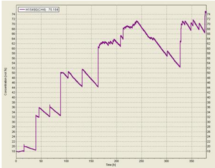
Figura 49 - Concentração de metano (%), na amostra da semana 16, operando com COV 0,25 kg CQO \cdot m^{-3} \cdot d^{-1} e QV 415 L \cdot m^{-3} \cdot d^{-1} .
