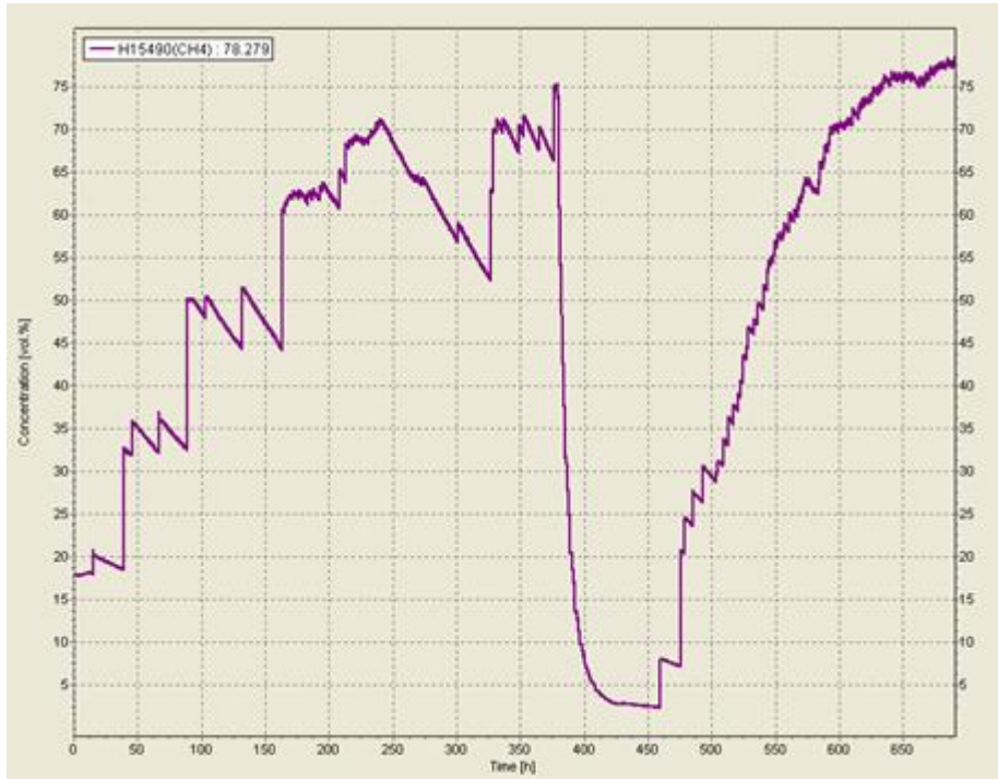
Figura 51 - Concentração de metano (%), na amostra da semana 18, operando com COV 1,1 kg CQO \cdot m^{-3} \cdot d^{-1} e QV 755 L \cdot m^{-3} \cdot d^{-1} .
