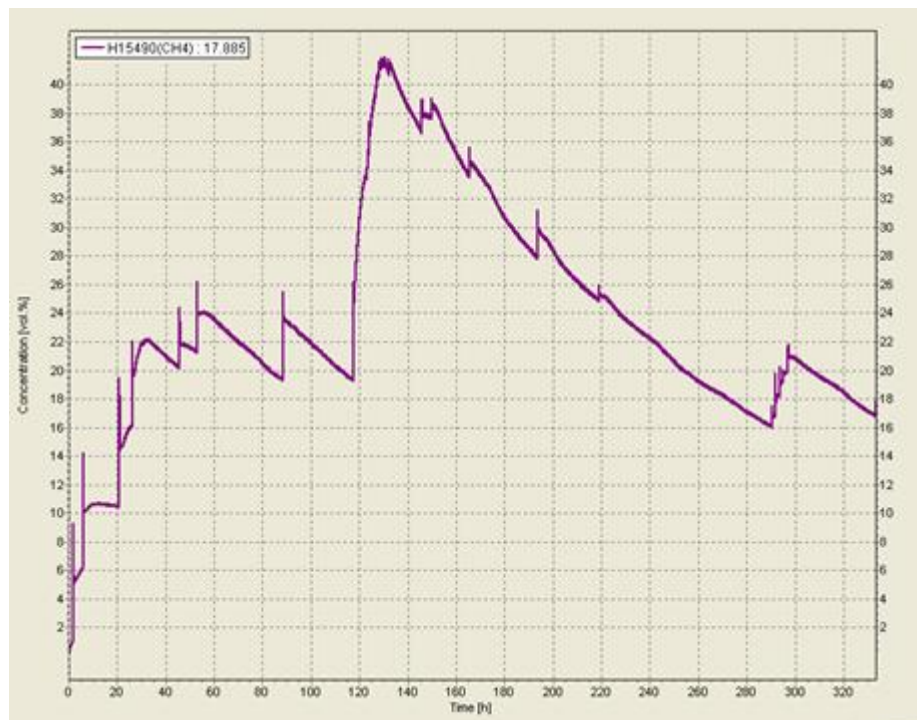
Figura 46 - Concentração de metano (%), na amostra da semana 13, operando com COV 0,03 kg CQO \cdot m^{-3} \cdot d^{-1} e QV 415 L \cdot m^{-3} \cdot d^{-1} .
