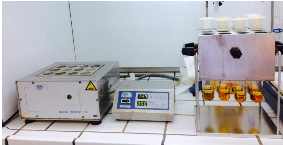
Figura 11 - Bloco de digestão e controlador para determinação da CQO (diâmetro 25 mm x 150 mm).
