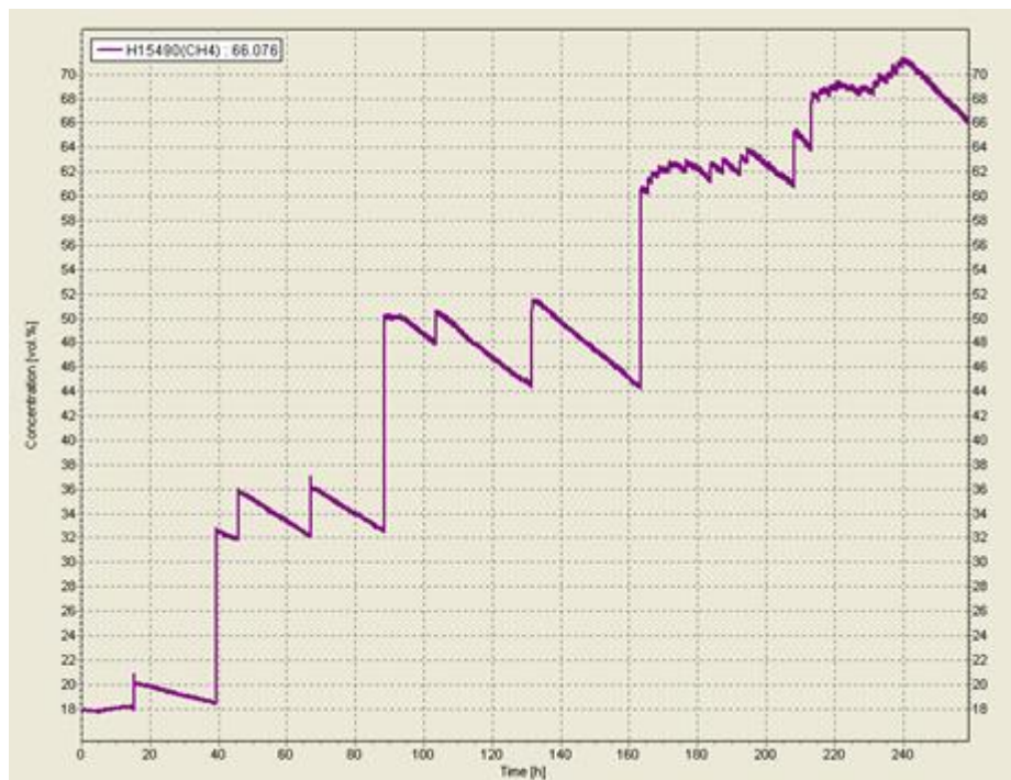
Figura 48 - Concentração de metano (%), na amostra da semana 15, operando com COV 0,07 kg CQO \cdot m^{-3} \cdot d^{-1} e QV 415 L \cdot m^{-3} \cdot d^{-1} .
