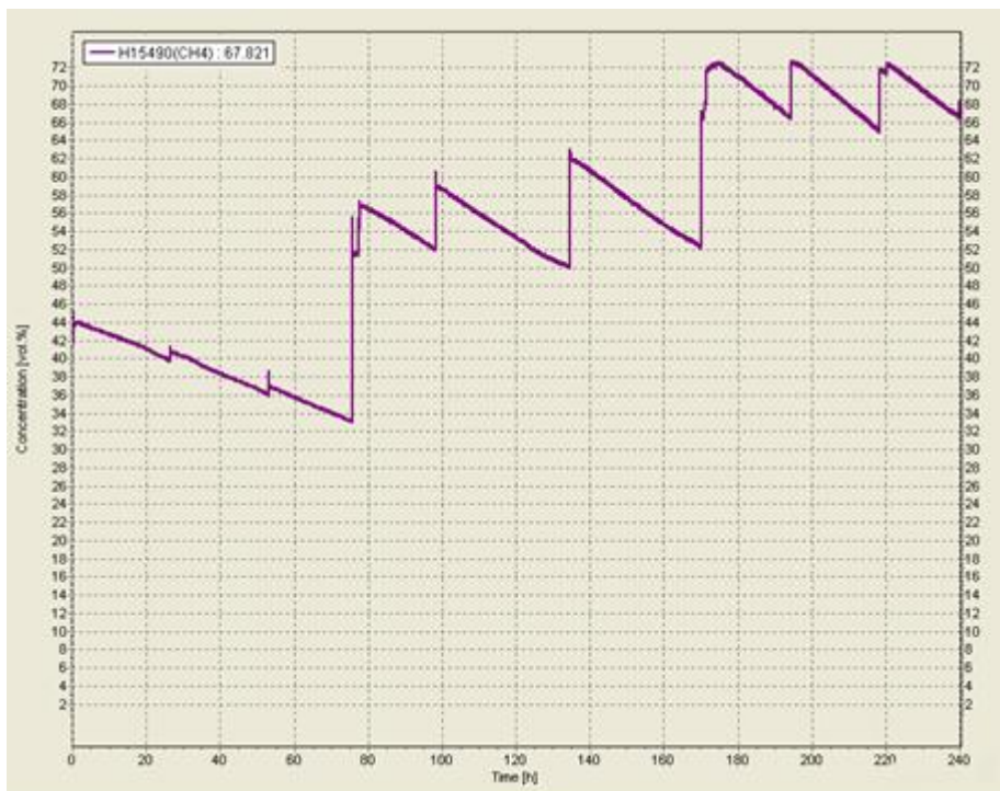
Figura 54 - Concentração de metano (%), na amostra da semana 21, operando com COV 2,3 kg CQO \cdot m^{-3} \cdot d^{-1} e QV 755 L \cdot m^{-3} \cdot d^{-1} .
