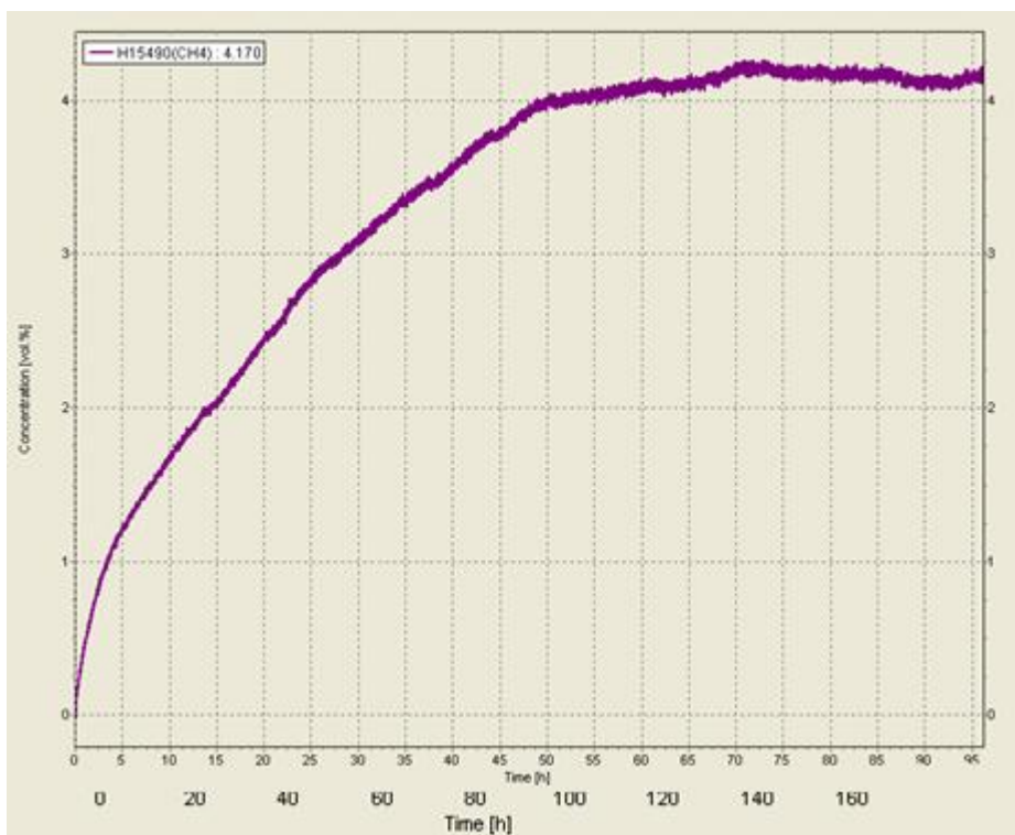
Figura 42 - Concentração de metano (%), na amostra da semana 8, operando com COV 0,38 kg CQO .m -3 .d -1 e QV 415 L.m -3 .d -1 .
