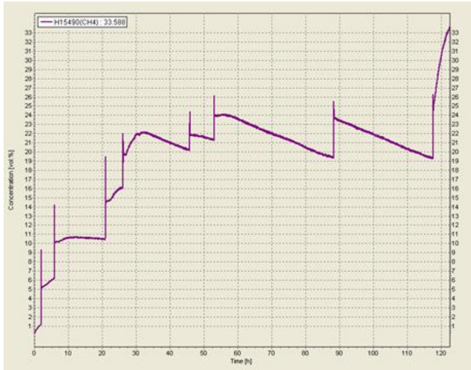
Figura 45 - Concentração de metano (%), na amostra da semana 11, operando com COV 0,10 kg CQO \cdot m^{-3} \cdot d^{-1} e QV 415 L \cdot m^{-3} \cdot d^{-1} .
