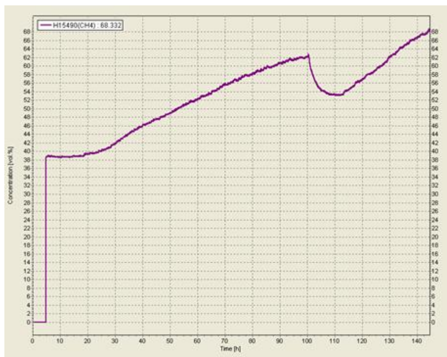
Figura 38 - Concentração de metano (%), na amostra da semana 4, operando com COV 0,66 kg CQO .m -3 .d -1 e QV 415 L.m -3 .d -1 .
