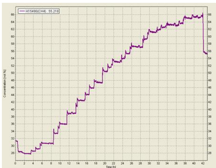
Figura 57 - Concentração de metano (%), na amostra da semana 24, operando com COV 15 kg CQO .m -3 .d -1 e QV 1509 L.m -3 .d -1 .
