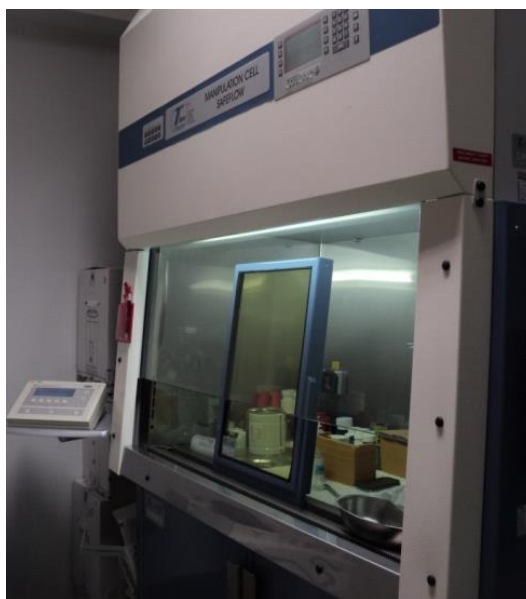
Figura 18 Representação de uma Hot Cells Safeflow .
