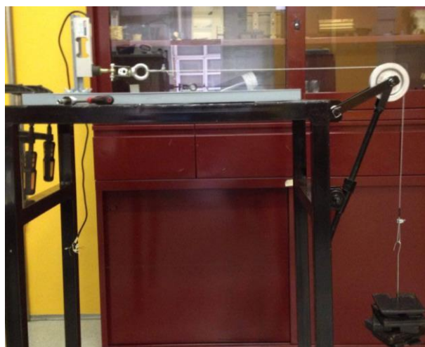
Figura 26 – Calibração da célula de carga do Projeto 3 utilizando as massas calibradas.
