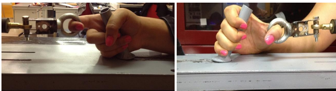
Figura 31 - Posição assumida para a medição dos esforços dos dedos na plataforma desenvolvida.
