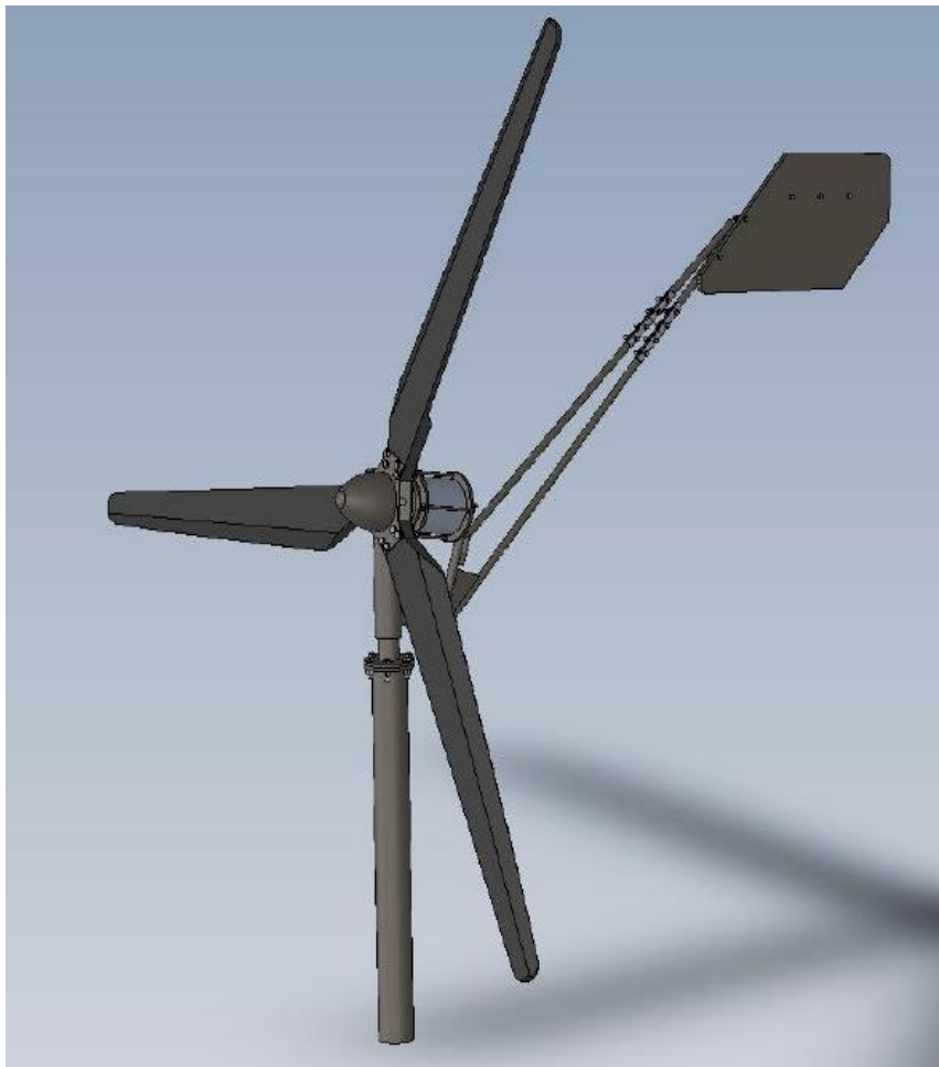
Figura 34: Desenho esquemático do aerogerador FORTIS modelo Passaat [30]
