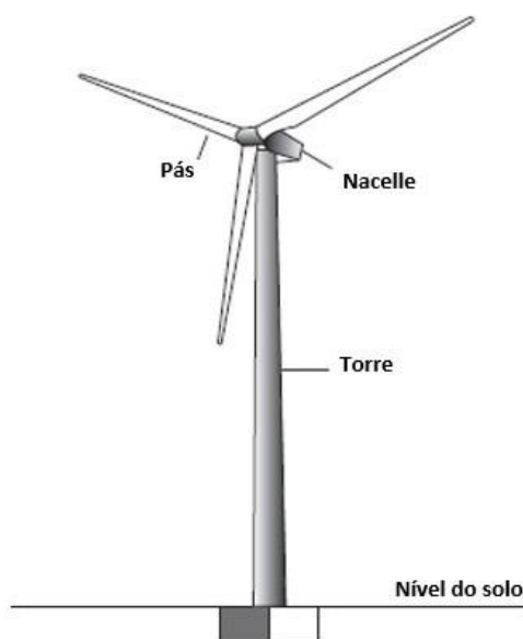
Figura 3: Esquema de Turbina de Eixo Horizontal com três pás [3]
