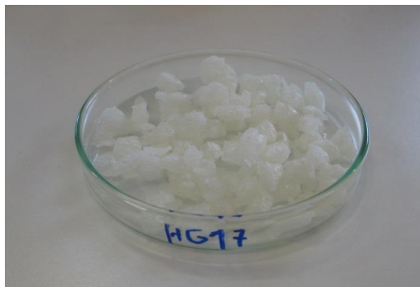
Figura 139: Exemplo de aspeto morfológico de um hidrogel após ter sido retirado da estufa de vácuo (HG17 considerado nesta ilustração).
