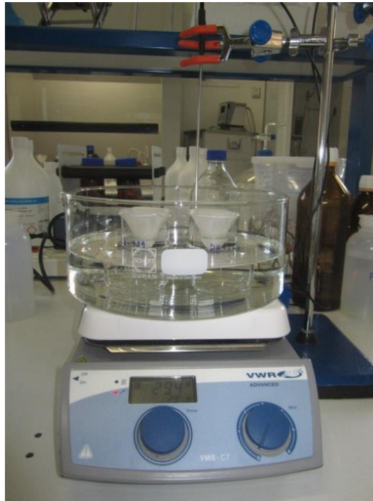
Figura 144: Ilustração do teste de sensibilidade equilíbrio dos hidrogéis à variação simultânea do pH e da temperatura.
