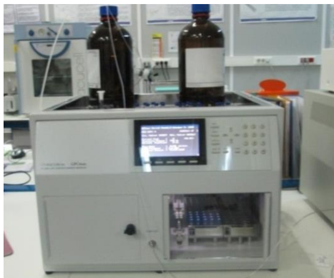
Figura 87: Ilustração fotográfica do equipamento de GPC utilizado para a análise dos produtos das polimerizações e na medição das quantidades de fármaco libertadas ao longo do tempo (mostra-se aqui apenas o módulo de bombagem do eluente que em geral consistiu em água com azida). Neste trabalho, a quantificação das concentrações de fármacos foi feita através de espectroscopia UV considerando duas abordagens experimentais diferentes: o modo aberto em que se monitoriza o pico de fármaco no sistema de GPC (representado nesta figura) e o modo fechado em que a absorção UV global das amostras é medida por comparação com a absorção da W_{DI} pura.
