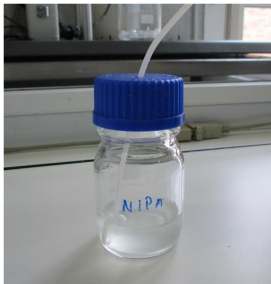
Figura 133: Ilustração do processo de borbulhamento do monómero com árgon previamente ao processo de polimerização. Desta forma, realiza-se a remoção de O_2 (que funciona como inibidor) do meio de polimerização. Este processo é também realizado durante a polimerização de forma a manter o meio reacional isento de O_2 .
