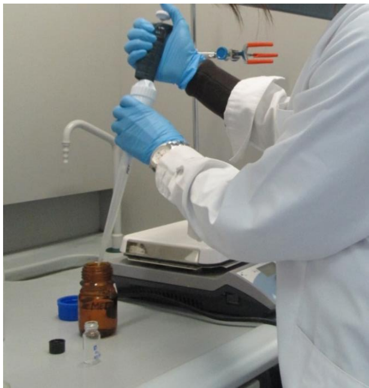
Figura 131: Ilustração do processo de recolha de metanol para utilização posterior na precipitação de hidrogéis sintetizados por suspensão inversa ou em solução.
