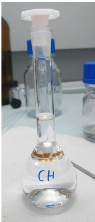
Figura 137: Ilustração de um balão volumétrico contendo ciclohexano usado no decorrer da síntese de hidrogéis em suspensão inversa. Neste processo de síntese, com o objetivo de realizar polimerização nas gotas de fase aquosa (síntese de partículas de hidrogel na fase dispersa), foram usados solventes orgânicos na fase contínua.
