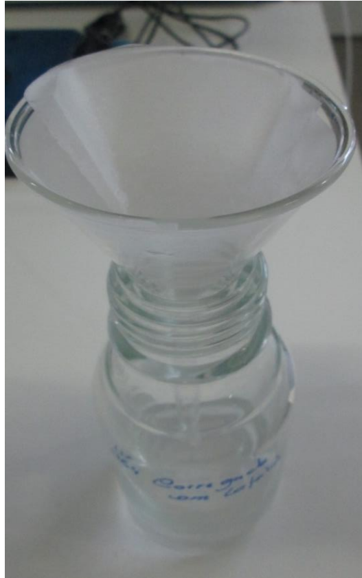
Figura 148: Ilustração do processo de filtração de hidrogéis carregados com fármacos (HG4 com cafeína usado como exemplo). Após esta fase foi recolhido e colocado numa estufa de vácuo. Método de carregamento B.
