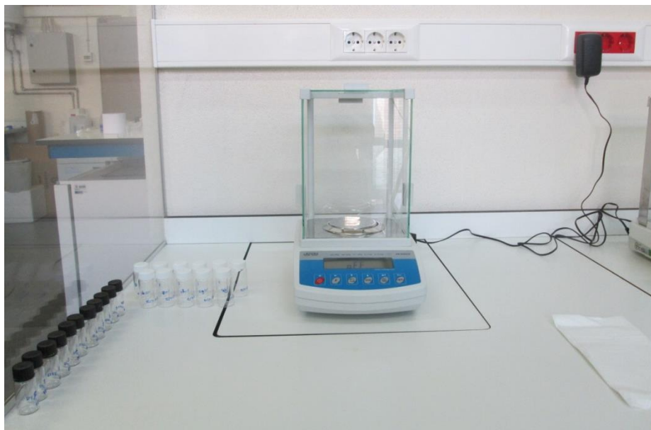
Figura 129: Ilustração da balança de precisão utilizada ao longo dos procedimentos experimentais deste trabalho. A pesagem rigorosa de todos os componentes utilizados na síntese dos hidrogéis e no processo de incubação e liberação de fármacos reveste-se de fundamental importância.
