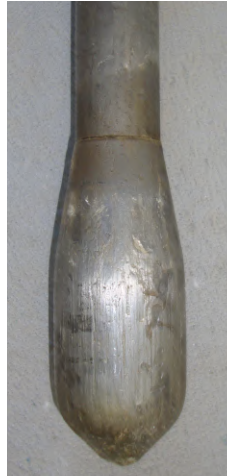
Figura 4 – Vara e ponteira usada no DPSH
