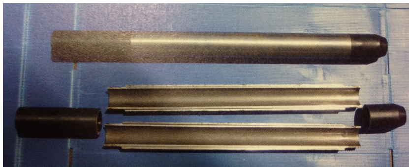
Figura 3 – Amostrador normalizado de Terzaghi.
