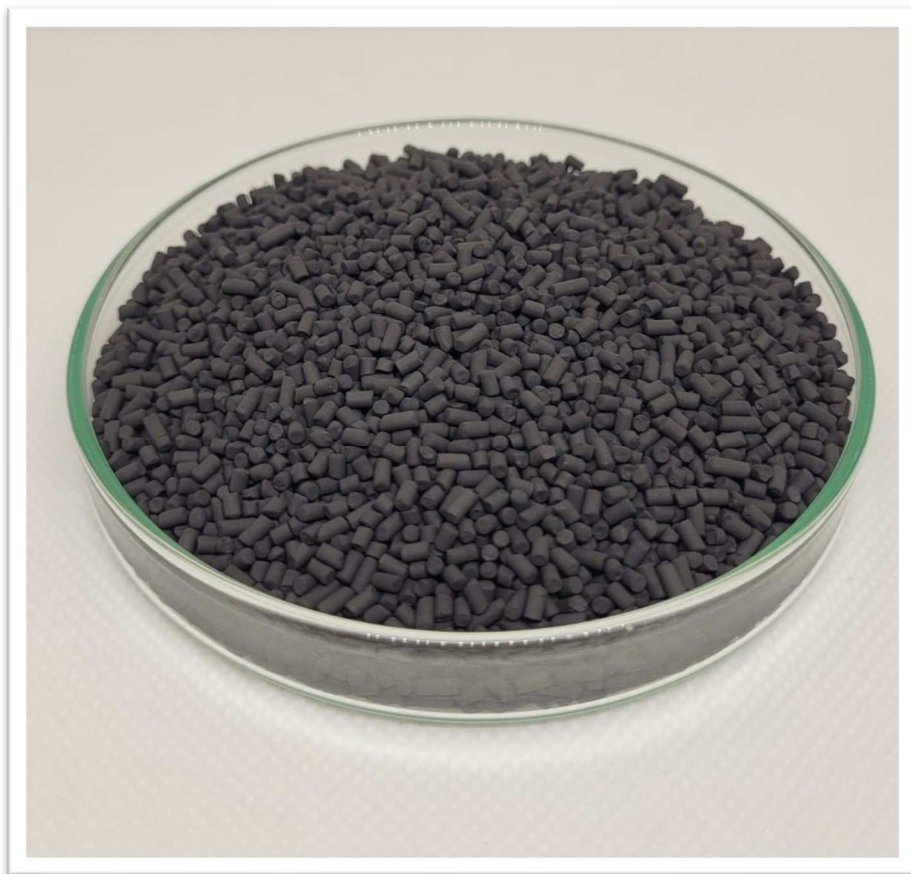
Imagem 4: Peneira Molecular de Carbono do tipo CMS-3K.
