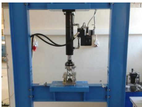
Figura 42 – Pórtico de reação
