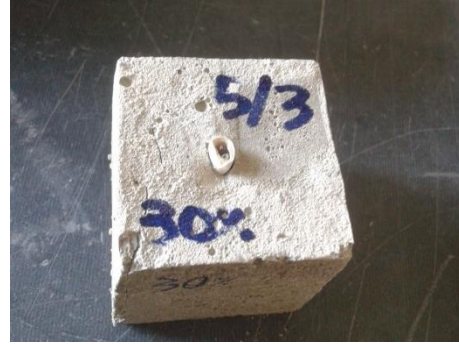
Figura 56 – Aspeto do provete após o ensaio da A_pcm
