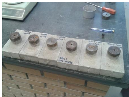
Figura 41 – Fixação de peças metálicas
