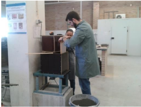
Figura 93 - Colocação do molde interior
