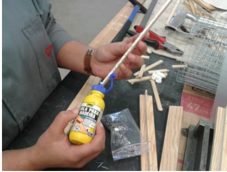
Figura 71 - Colagem e pregagem dos perfis
