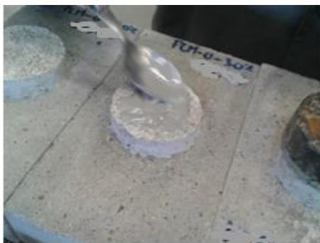
Figura 40 - Colocação da cola Epoxi
