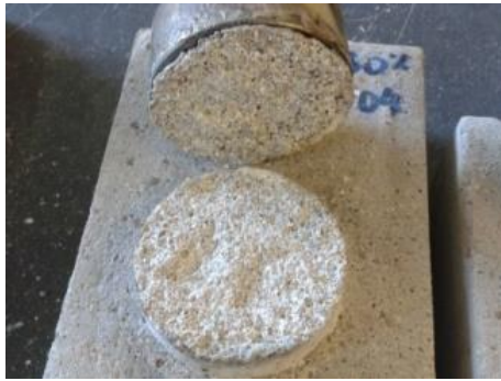
Figura 48 - Rotura pela argamassa
