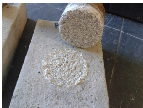
Figura 46 – Rotura pela interface
