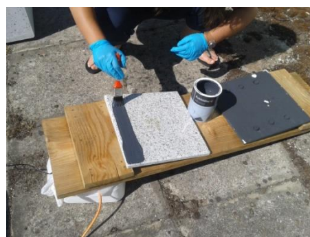
Figura 142 - Pintura do painel de granito
