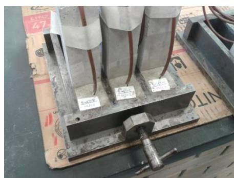
Figura 23 - Colocação de termopares
