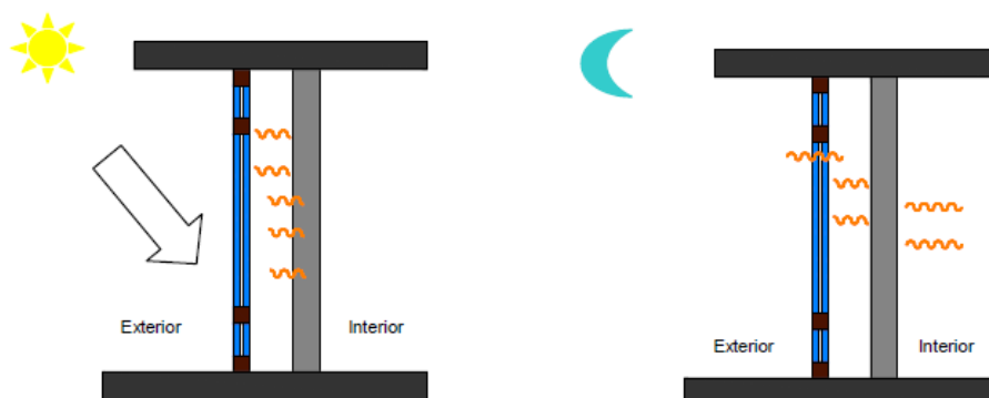
Figura 7 - Esquema de funcionamento da parede de trombe não ventilada, dia e noite [7]
