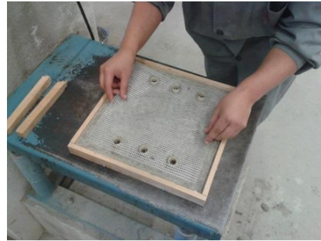
Figura 113 - Colocação da fibra de vidro
