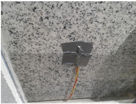
Figura 134 – Primeira fixação de termopares
