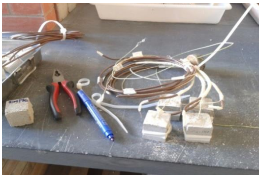
Figura 51 - Remoção dos termopares
