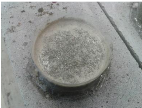
Figura 36 – Colocação da argamassa no molde transparente
