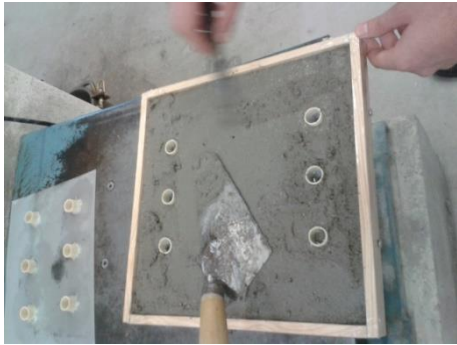
Figura 112 - Colocação da argamassa
