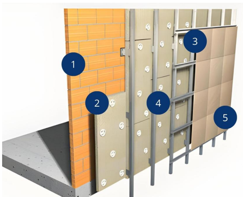
Figura 3 – Composição da parede externa com revestimento independente com interposição de isolante térmico na caixa de ar Fonte: (CYPE Ingenieros, 2025)
