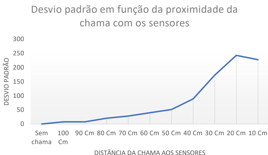
Figura 5.6- Desvio padrão em função da proximidade da chama com os sensores.
