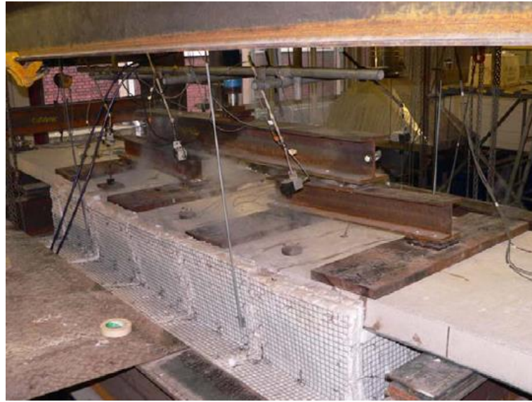
Figura 37: Ensaio de laje mista submetida a carregamento mecânico em incêndio natural (S. Guo [23]).
