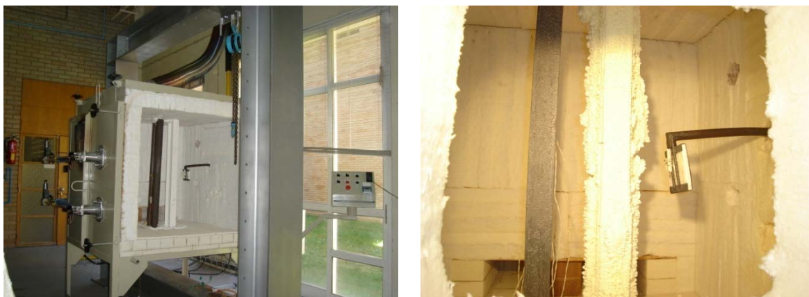
Figura 5.33 – Elemento estruturais com e sem protecção no forno de ensaios.
