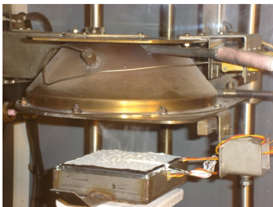
Figura 4.9 – Preparação do ensaio no calorímetro de cone.
