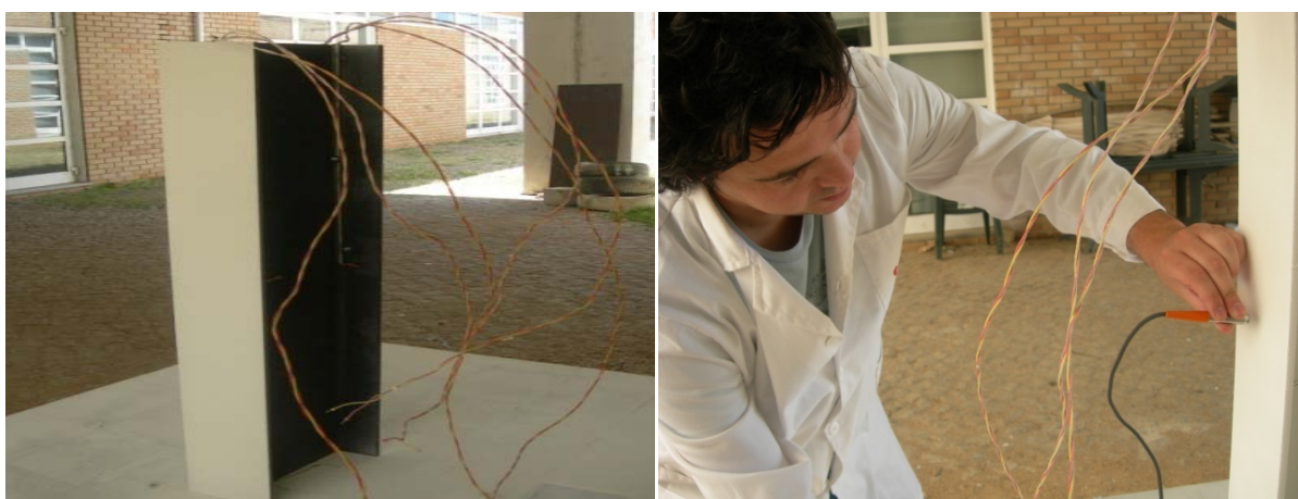
Figura 5.43 – Control de espessura na cama de protecção.
