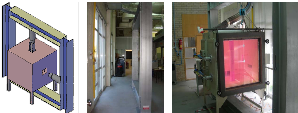
Figura 1.1 – Instalação laboratorial para ensaios de resistência de elementos estruturais (vigas e pilares) em condições de incêndio, protegidos com tinta intumescente.
