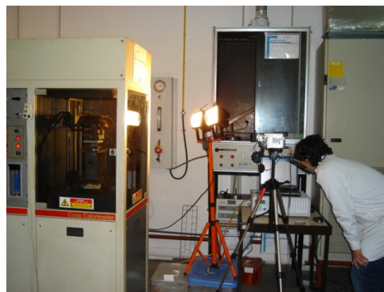
Figura 4.9 – Preparação do ensaio no calorímetro de cone.
