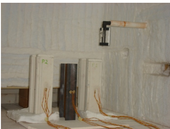
Figura 5.23 – Visualização dos elementos estruturais com e sem protecção no interior do forno.
