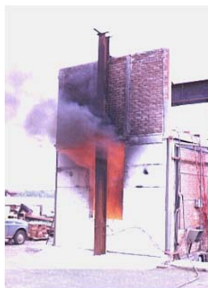
Figura 3.5 – Ensaio em laboratório de fogo externo.
