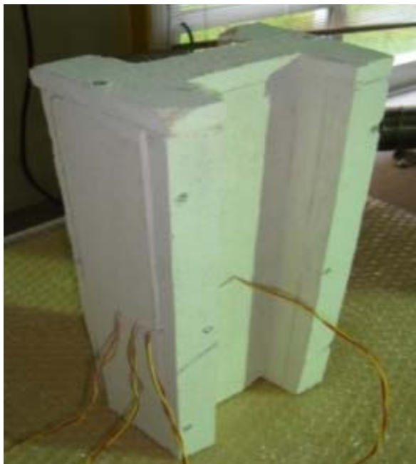
Figura 5.19 – Elemento estrutural com protecção de silicato de cálcio.
