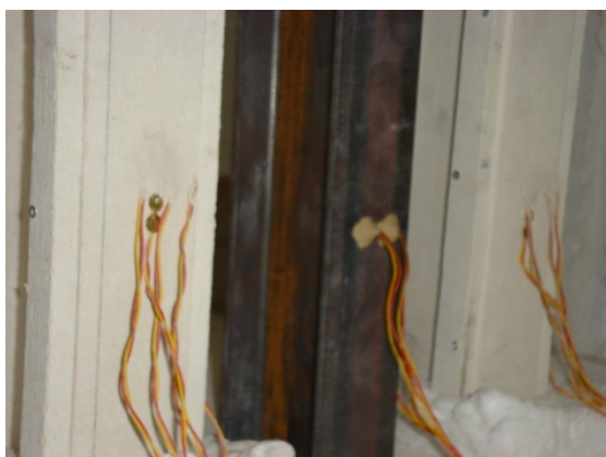
Figura 5.23 – Visualização dos elementos estruturais com e sem protecção no interior do forno.
