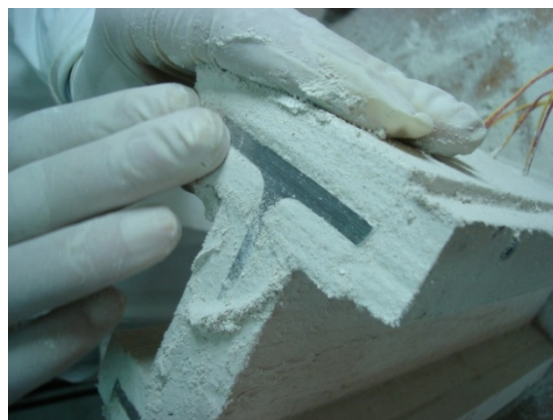
Figura 5.22 – Isolamento do elemento estrutural em silicato de calcio.
