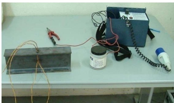
Figura 5.21 – Processo de soldadura de termopares no elemento estrutural.
