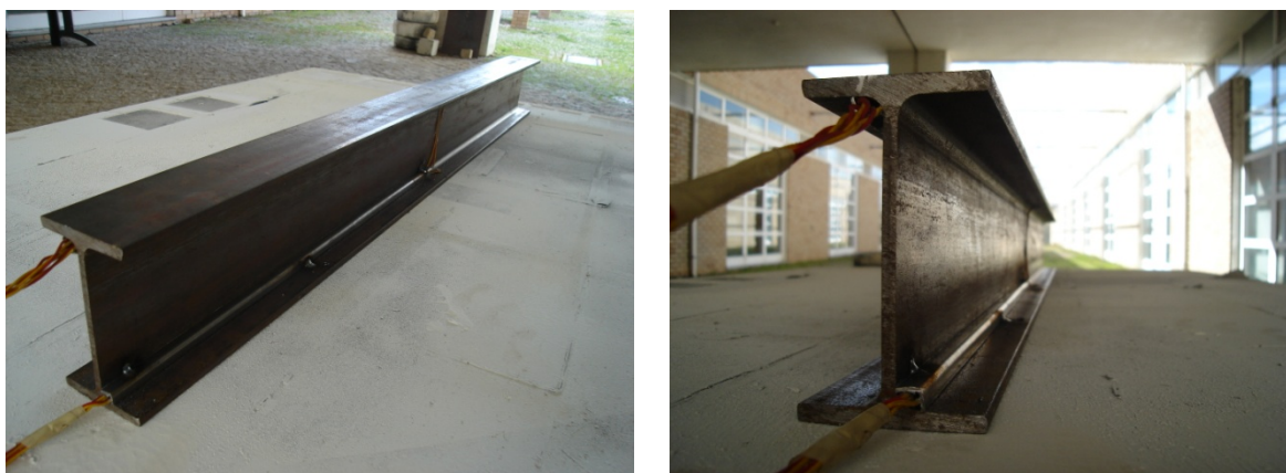
Figura 5.30 - Posição dos termopares para leitura das temperaturas no IPE100
