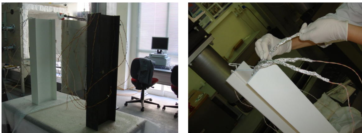
Figura 5.45 – Protecção dos fios termopar com alumínio.
