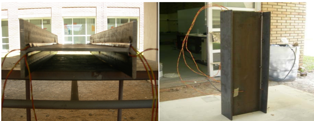
Figura 5.42 – Calha em inox para proteger os fios termopar.
