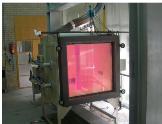
Figura 5.1 – Forno de Ensaios de Resistência ao Fogo, IPB.
