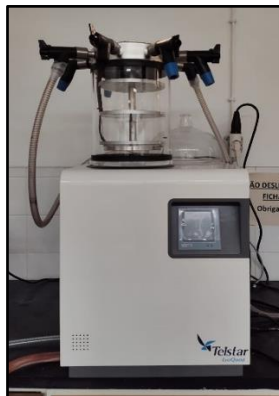
Figura 7 - Liofilizador utilizado para secagem e determinação de humidade das amostras.
