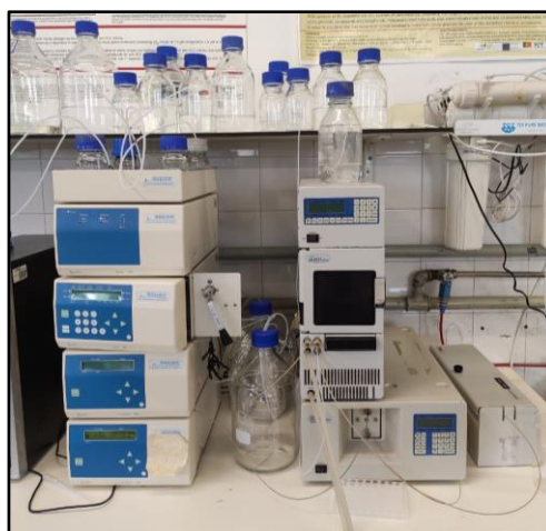
Figura 11 – Equipamento HPLC-RI utilizado para separação e identificação de açúcares solúveis.
