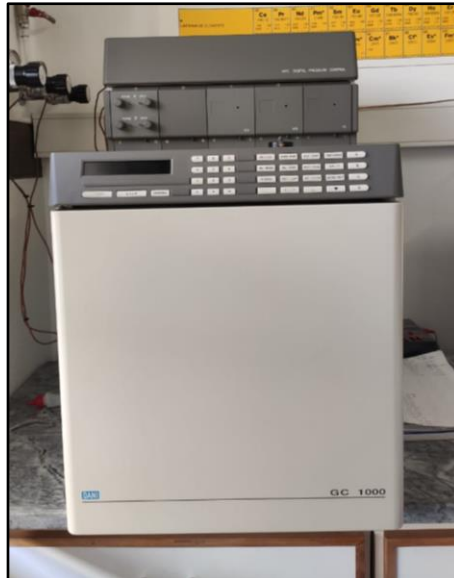
Figura 12 - Equipamento GC-FID utilizado para separação e identificação de ácidos gordos.
