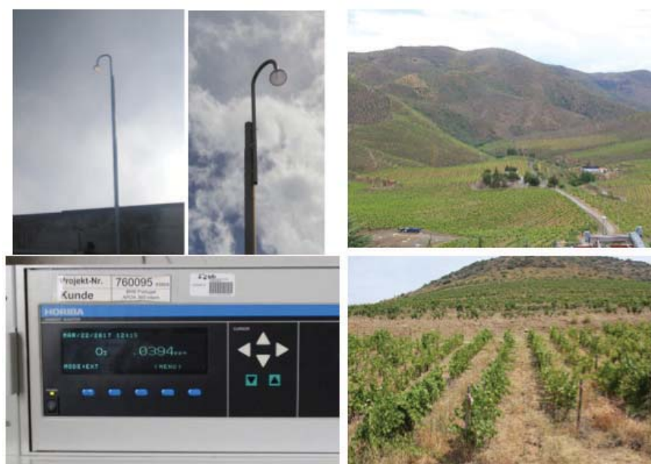
Figura 4.3. Equipamento de monitorização da concentração de ozono no Douro superior, Quinta da Leda - Sogrape.
