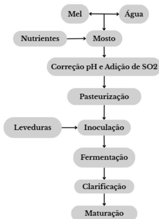
Figura 4 - Fluxograma do processo de produção do hidromel (adaptado de [67]) .
