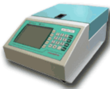
Figura 3 – Aparelho utilizado para a medição de a_w , LabMASTER-aw da Novasina. [11]
