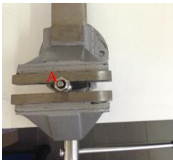
Figura 14 – Coluna empacotada com MOF. O MOF é vertido para o orifício representado pela letra A.
