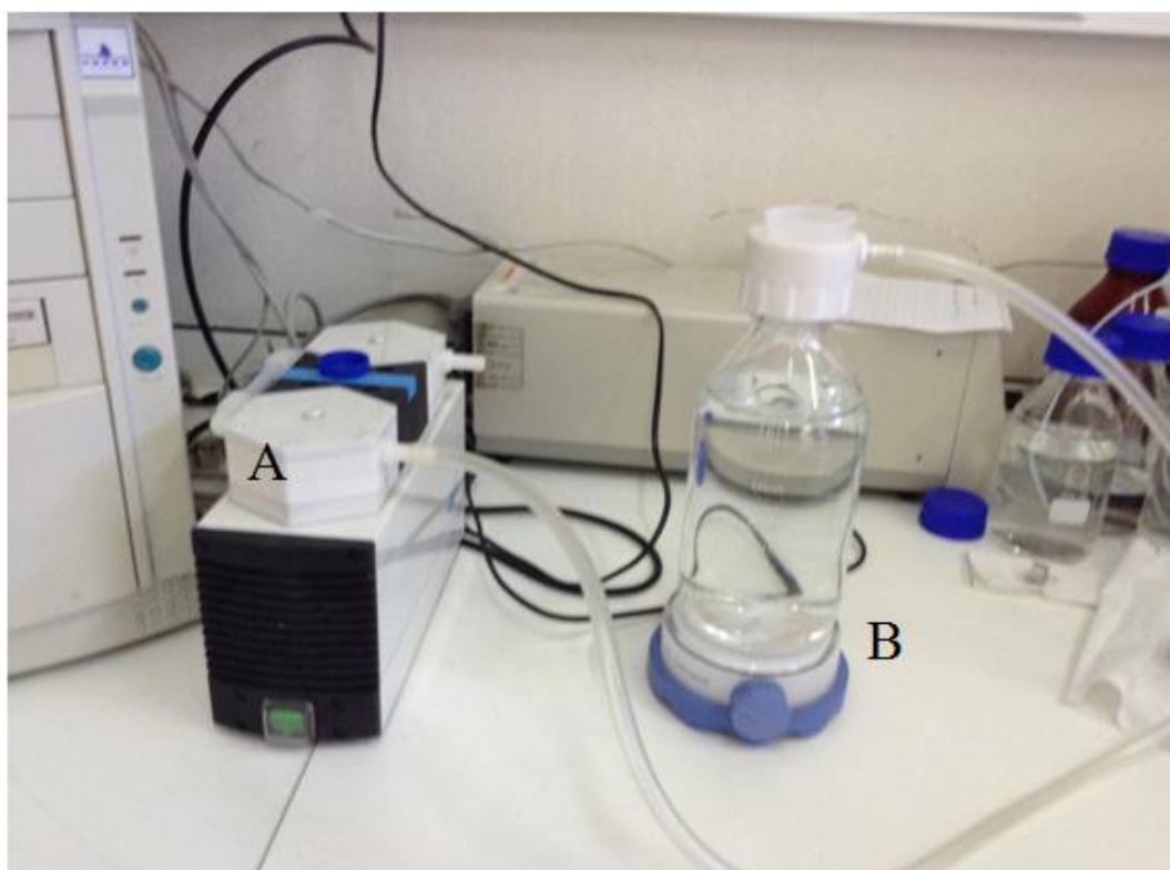
Figura 12 – Sistema de desgaseificação. A) Bomba de vácuo. B) Placa de agitação.
