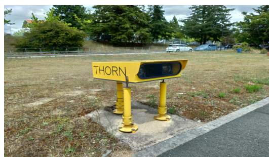
Figura 2.29: Indicador de Percurso de Aproximação de Precisão (PAPI), Heliporto de Bragança, Portugal.
