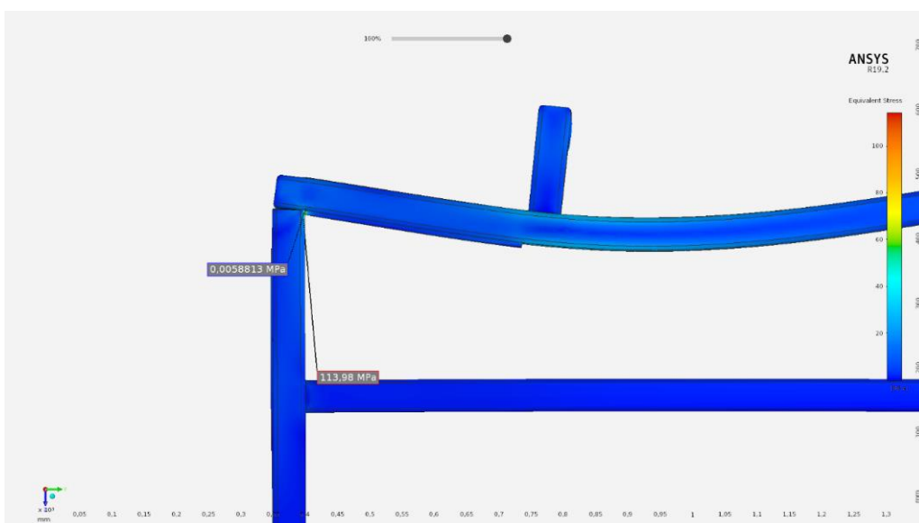
Figura 26 - Tensão máxima equivalente de von-Mises na bancada.
