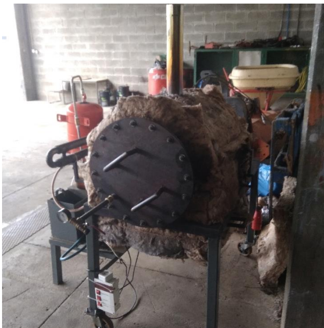
Figura 46 - Ensaio com RSU do forno Carbonizador, nota-se a utilização de lã mineral para reter calor dentro da capa da fornalha (conforme descrito em 3.2.3)
