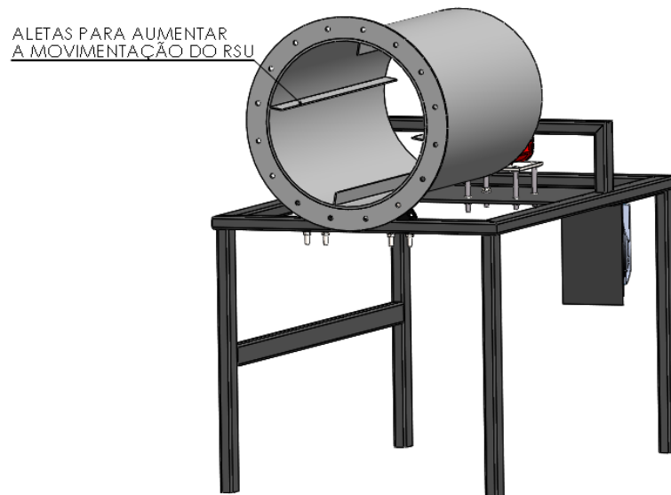
Figura 38 - Aletas para movimentação do RSU dentro do tambor rotativo, conforme item 3.4
