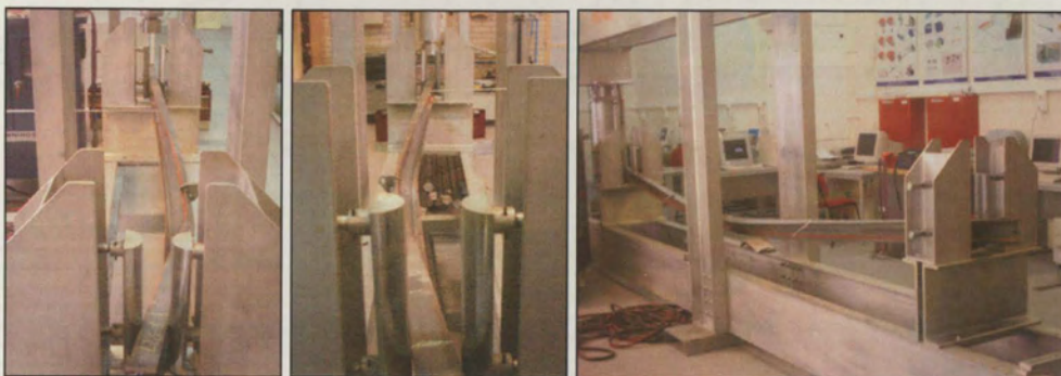
Figura 4.23 – Deformada das vigas com 2.5, 3.5 e 4.5 [m], da esquerda para a direita, respectivamente.
