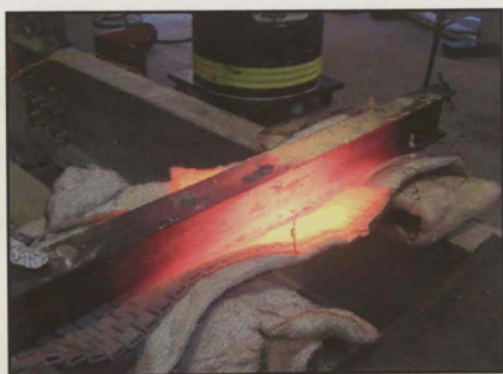
Figura 3.10 – Viga aquecida a 800 [°C] durante 1h.
