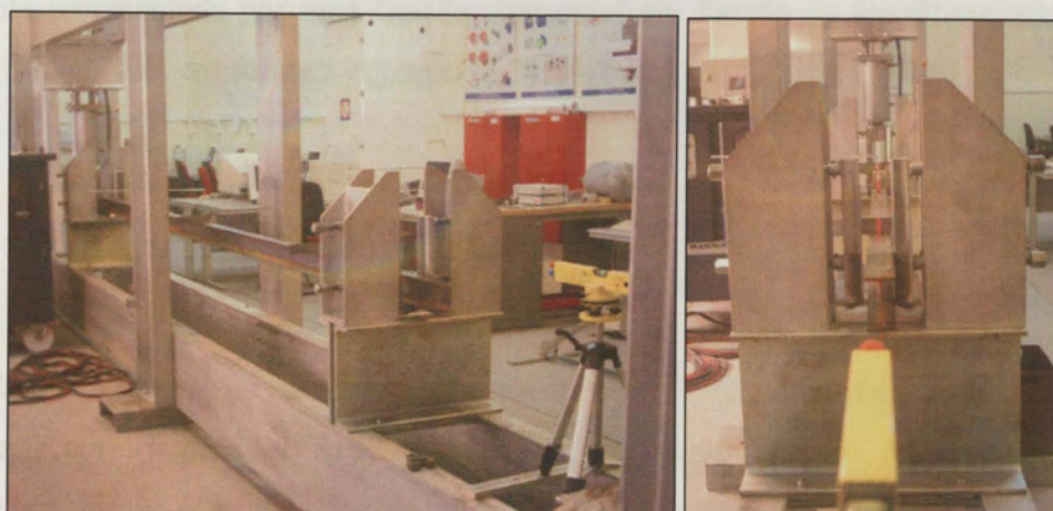
Figura 4.9 – Feixe laser para medição das imperfeições.
