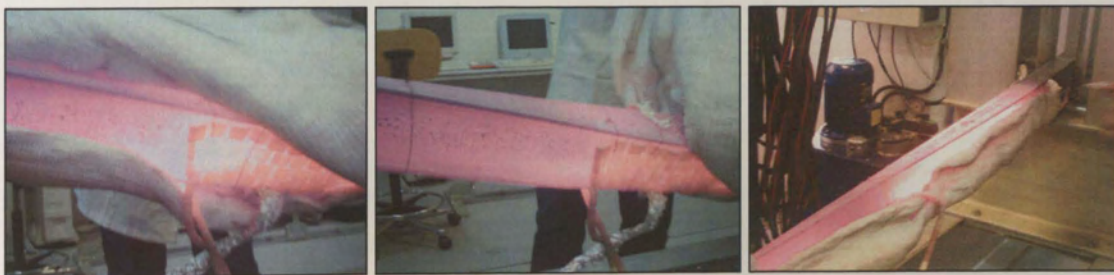
Figura 4.21 – Viga na fase final do ensaio.
