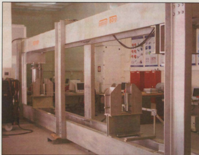
Figura 4.10 – Pórtico de reacção.
