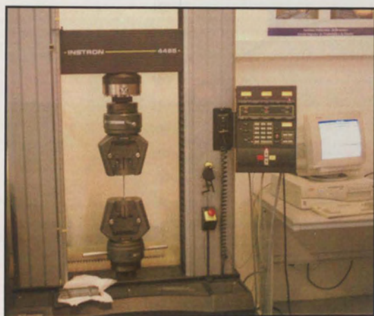
Figura 4.4 – a) Máquina de ensaios universal Instron 4485. b) Instalação do extensômetro mecânico.
