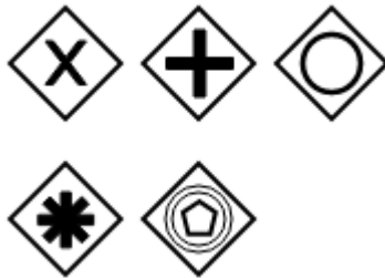
Figura 2.9: Exemplos de gateways do BPMN, na sequência por linha: gateway exclusivo, paralelo, inclusivo, complexo, e baseado em eventos.
