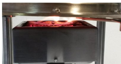
Figura 11: Amostra de madeira tricapa. Ignição (esq.), b) Extinção da chama (dta).
