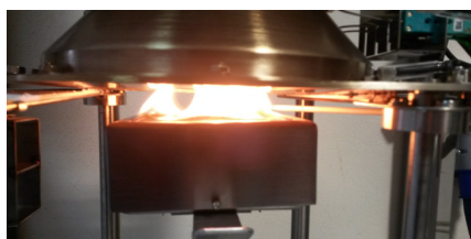
Figura 11: Amostra de madeira tricapa. Ignição (esq.), b) Extinção da chama (dta).
