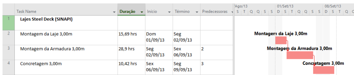
Figura 41 - Gráfico Gantt com Caminho Crítico de Laje Steel Deck com vão de 3 metros (SINAPI)
