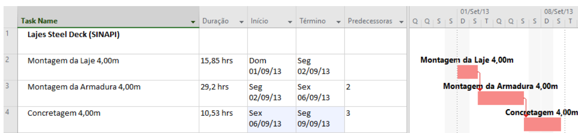
Figura 39 - Gráfico Gantt com Caminho Crítico de Laje Steel Deck com vão de 4 metros (SINAPI)
