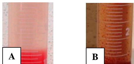
Figura 5.3 – A: sobrenadante límpido resultante da solução com PEG 10 com concentração de 10 g/L; B: sobrenadante com sujidade resultante do PEG 10 com concentração de 100 g/L.
