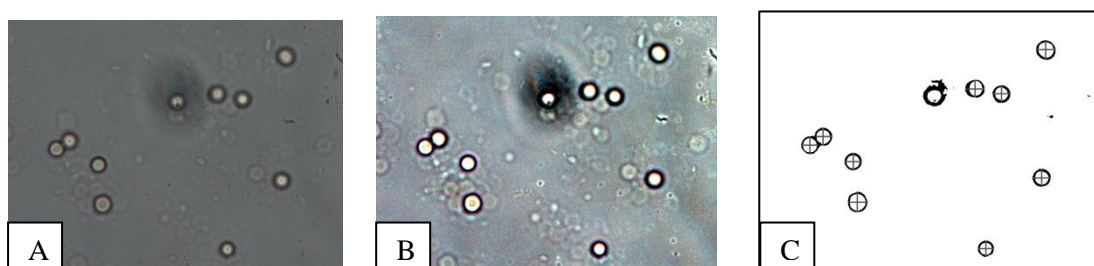
Figura 5.8 – A - Imagem original com GVs obtida no microscópio invertido; B - Imagem dos GVs após o pré-processamento, filtragem e realce de contraste; C - Segmentação da imagem, por binarização, e, determinação dos diâmetros horizontal e vertical, de cada uma das células.
