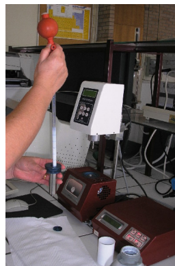
1. Introdução da amostra de PUD no compartimento de amostragem do viscosímetro.
