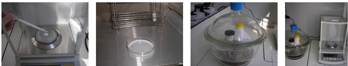
Figura 39. Exemplo do procedimento realizado para a determinação do teor de sólidos.
