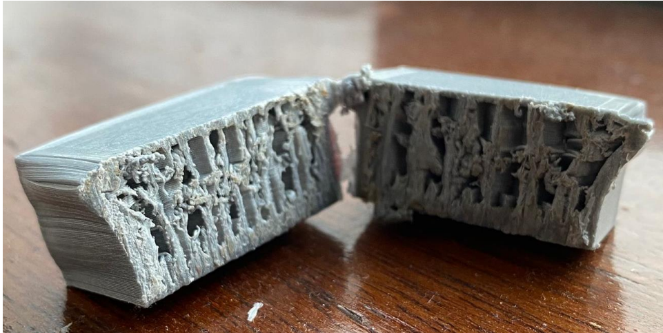
Figura 39- Interior da estrutura quando aplicada carga na direção Z.
