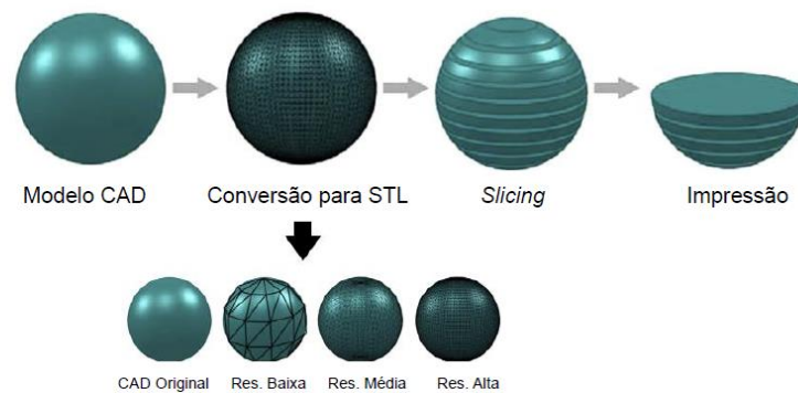
Figura 2- Processo do Fabrico Aditivo (Adaptado de [39]).
