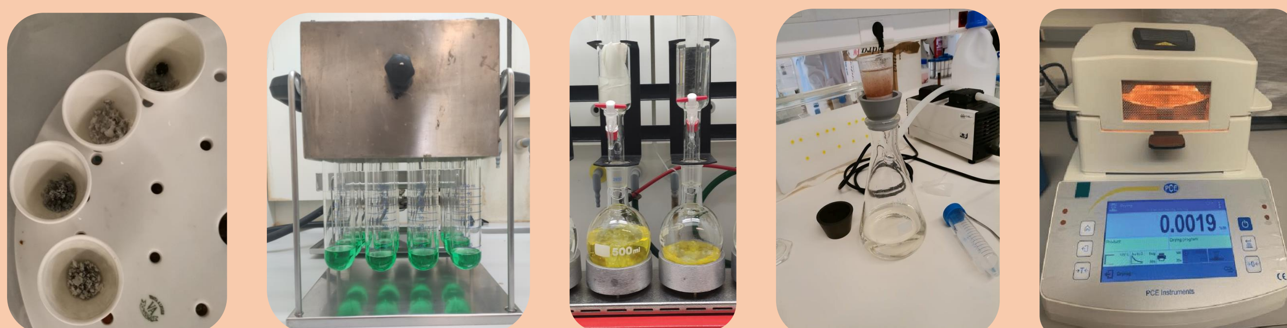
Fig. 2. Ilustração dos métodos oficiais de determinação de cinzas, proteínas, gordura bruta, fibra alimentar e humidade.
