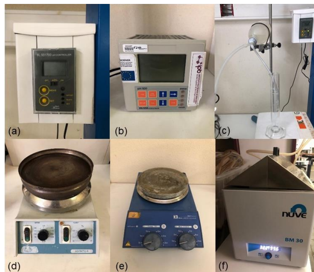
Figura 6. Componentes do sistema de digestão anaeróbia: (a), (b) Medidor de pH; (c) Frasco PE e proveta graduada; (d) e (e) Placas de agitação (f) Banho termostático.
